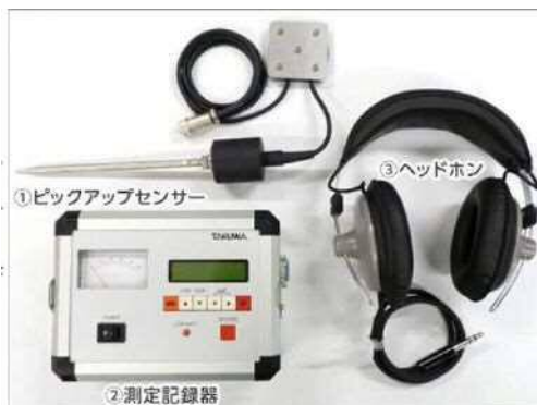
写真.1 地下流水音測定装置
